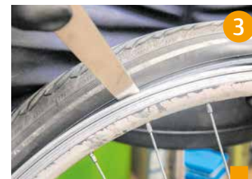
Schutzkappe und Ventilhaltermutter runtergeben. Mit einem Reifenheber (oder dem hinteren Ende eines Suppenlöffels) den Reifen vorsichtig Stück für Stück über den Felgenrand heben, den Schlauch mit den Fingern herausziehen.
