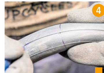
Loch suchen (vorher Schlauch ein wenig aufpumpen), Fremdkörper entfernen und markieren.
