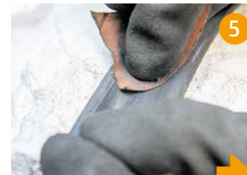
Mit einem Schmirgelpapier den Bereich um das Loch in der Größe des Klebeflickens aufrauen.
