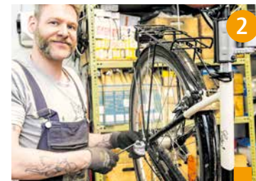
Das betroffene Rad wird ausgebaut, die Bremsen vorher lösen, die Kette aushängen.
