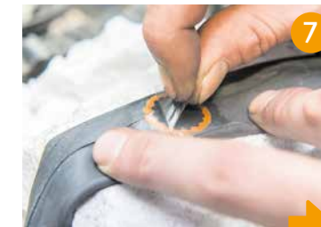
Flicken raufgeben, mit der Rückseite des Reifenhebers Luftbläschen rausrubbeln, Folie abziehen.
