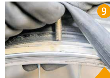
Schlauch in den Mantel legen, Ventil einfädeln (das muss gerade sitzen), ein wenig aufpumpen.
