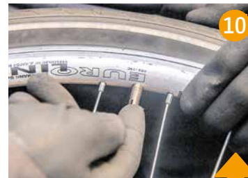
Beginnend beim Ventil den Mantel mit beiden Händen über die Felge heben. Das Ventil kurz hineindrücken (Bild), damit der Schlauch nicht eingezwickelt wird.
