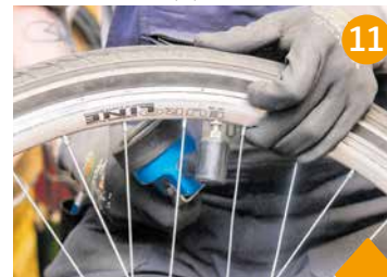
Überwurfmutter raufdrehen, Reifen aufpumpen und Rad wieder einbauen. Die Bremse einhängen!
