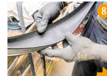
Fremdkörper innen und außen vom Mantel entfernen, im inneren mit Talkum/Babypuder bestäuben.
