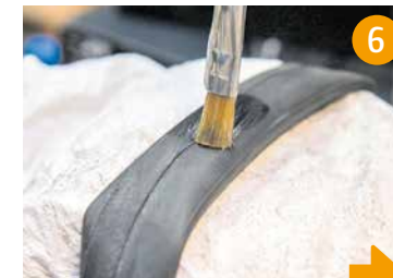
Den Kleber (Vulkanisierungsflüssigkeit) auftragen und mindestens fünf Minuten trocknen lassen.
